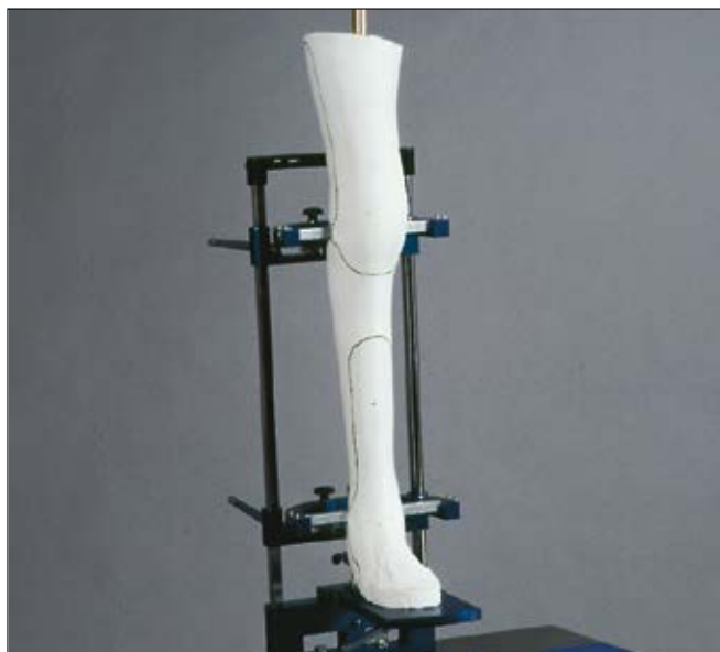
Positif en plâtre prêt avec lignes de fabrication tracées.
